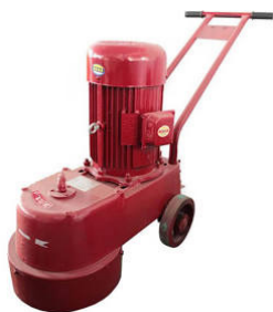
Máy mài sàn bê tông DMS350-7.5 KW
